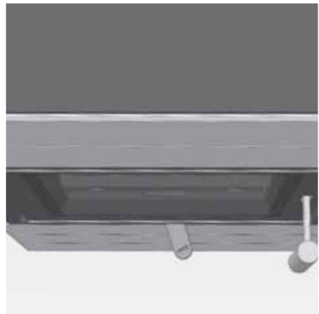
Abb. 4.11 Verbrennungslufthebel ganz rechts, Verbrennungsluft komplett geöffnet, Anheizen
