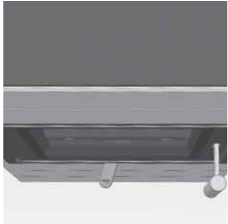
Abb. 4.3 Verbrennungslufthebel ganz links, Verbrennungsluft geschlossen
