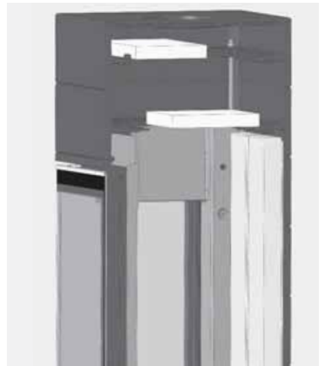
Abb. 4.31 Entnehmen der Umlenkungen (CORNA ES, Heizgasführung)
