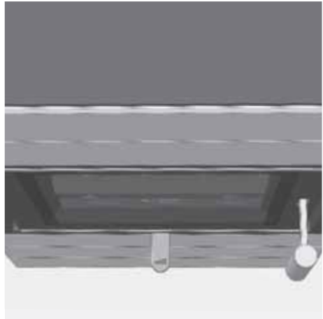
Abb. 4.9 Verbrennungslufthebel mittig, Verbrennungsluft auf Nennwärmeleistung
