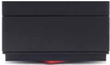
Abb. 4.27 LED-Lichtsignal „ROT blinkend“ - auch nach Abbrandende
