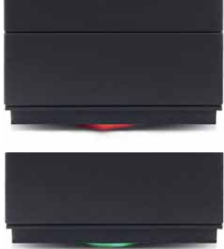
Abb. 4.26 LED-Lichtsignal bei Betrieb „ROT“ dann wieder „GRÜN“
