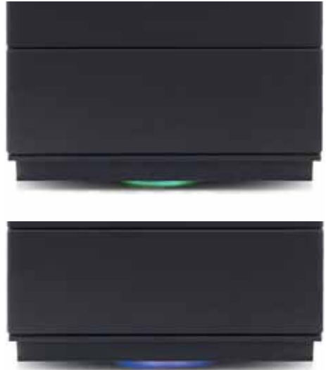
Abb. 4.23 LED-Lichtsignal zunächst „GRÜN“ dann „BLAU“
