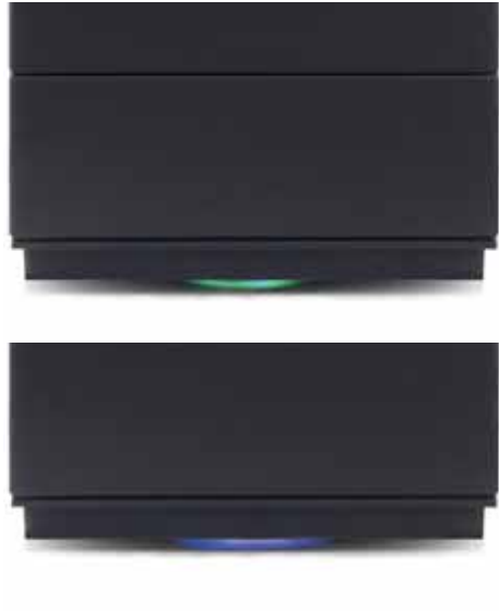
Abb. 4.24 LED-Lichtsignal zunächst „GRÜN“ dann „BLAU“
