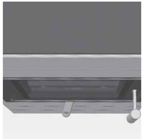
Abb. 4.10 Verbrennungslufthebel ganz links, Verbrennungsluft geschlossen
