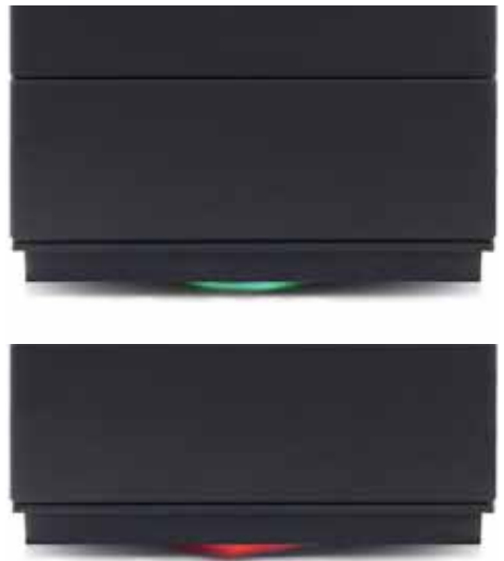
Abb. 4.19 LED-Lichtsignal zunächst „GRÜN“ dann „ROT“
