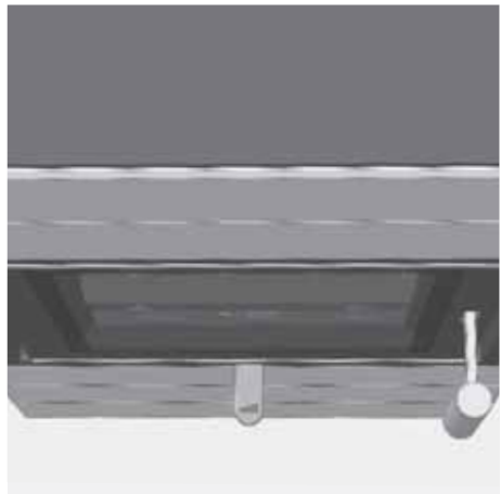
Abb. 4.5 Verbrennungslufthebel mittig, Verbrennungsluft auf Nennwärmeleistung
