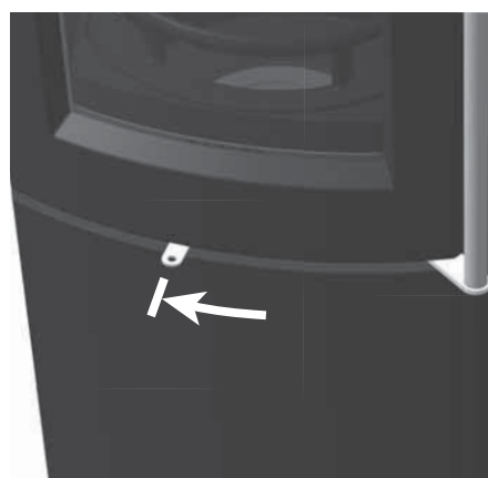
Abb. 4.19 Verbrennungslufthebel ganz links, Verbrennungsluft geschlossen
