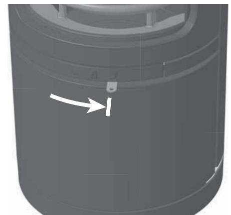
Abb. 4.19 Verbrennungslufthebel ganz rechts, Anheizstellung
