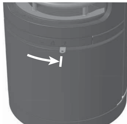
Abb. 4.11 Verbrennungslufthebel ganz rechts, Anheizstellung
