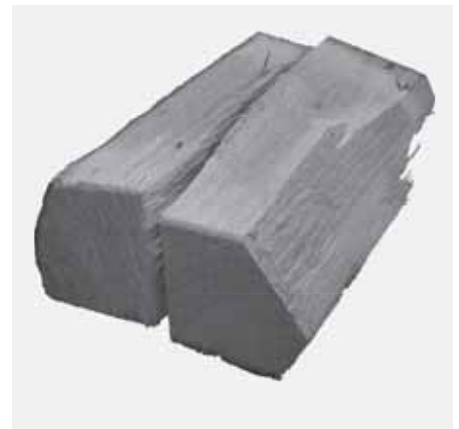
Abb. 4.21 Holzaufgabe mit 2 Holzscheiten – NOVIA C (ohne Wassertechnik), Auflage längs im Brennraum
