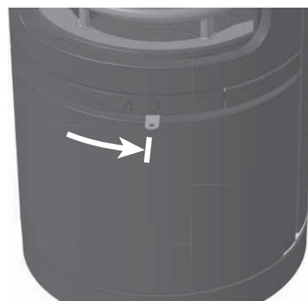
Abb. 4.12 Verbrennungslufthebel ganz rechts, Anheizstellung
