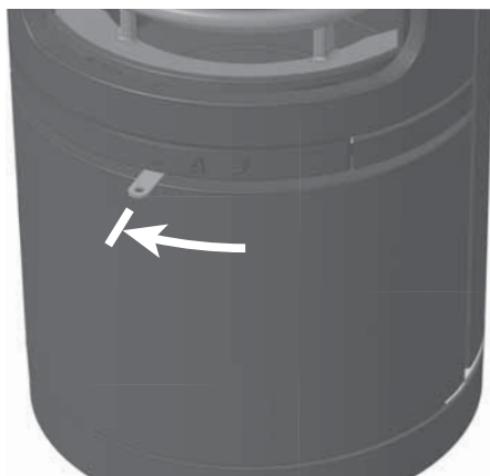
Abb. 4.9 Verbrennungslufthebel ganz links, Verbrennungsluft geschlossen
