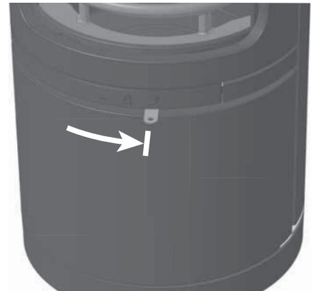
Abb. 4.17 Verbrennungslufthebel ganz rechts, Anheizstellung
