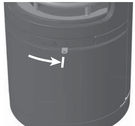
Abb. 4.22 Verbrennungslufthebel ganz rechts, Anheizstellung
