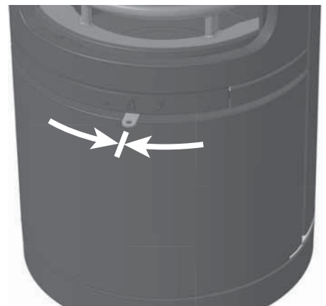
Abb. 4.23 Verbrennungslufthebel ungefähr 1/3, Verbrennungsluft offen, Nennwärmeleistung
