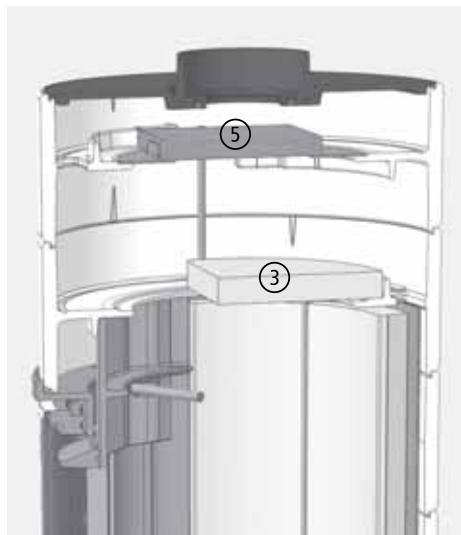
Abb. 3.3 Lage der Katalysatorplatten beim PEPPA tec, Schnittdarstellung
