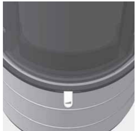
Abb. 4.9 Verbrennungslufthebel ca. 60%, ein kleines Stück rechts der Mitte, Verbrennungsluft auf Nennwärmeleistung
