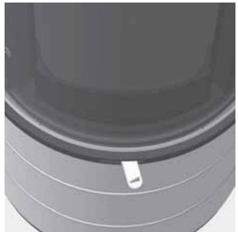
Abb. 4.6 Verbrennungslufthebel ganz rechts, Verbrennungsluft komplett geöffnet, Anheizen
