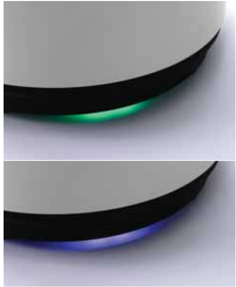
Abb. 4.23 LED-Lichtsignal zunächst „GRÜN“ dann „BLAU“
