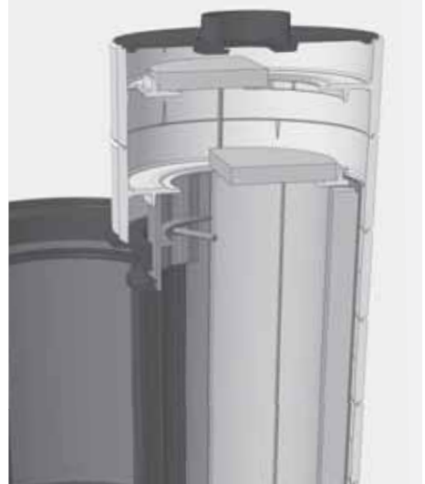
Abb. 4.36 Entnehmen der Umlenkungen (Heizgasführung)
