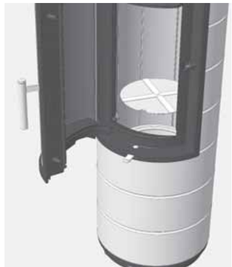
Abb. 4.34 Entnehmen des Bodenblechs im Brennraum
