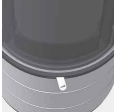
Abb. 4.11 Verbrennungslufthebel ganz rechts, Verbrennungsluft komplett geöffnet, Anheizen
