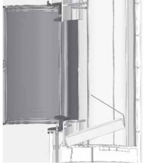
Abb. 4.30 Anheben des Bodensteins im Brennraum
