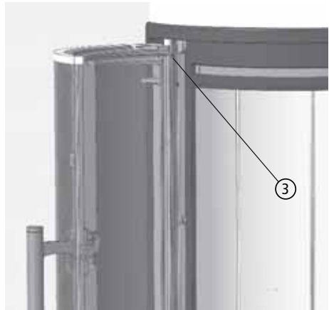
Abb. 3.7 Madenschraube, Stiftsicherung lösen
