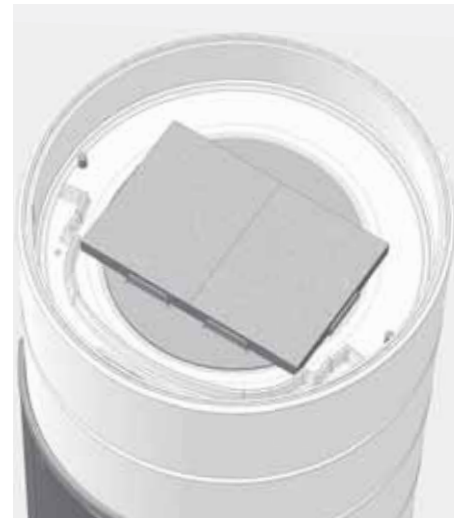
Abb. 2.5 Lage der Katalysatorplatten, Blick von oben bei abgenommener Deckplatte
