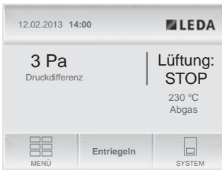
Abb. 7.4 Anzeige bei einer Störung
