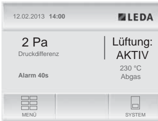
Abb. 7.3 Anzeige bei einer Störung
